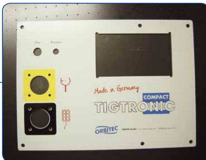
Klare Acrylglas-schilder rückseitig im Siebdruck bedruckt und mit Etched-Glass Folie hinterlegt.
