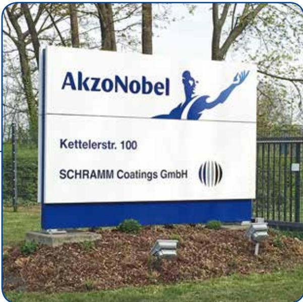
Werbepylon aus Aluminium, lackiert. Beschriftung im Plottverfahren, Beleuchtung über Bodenstrahler.
