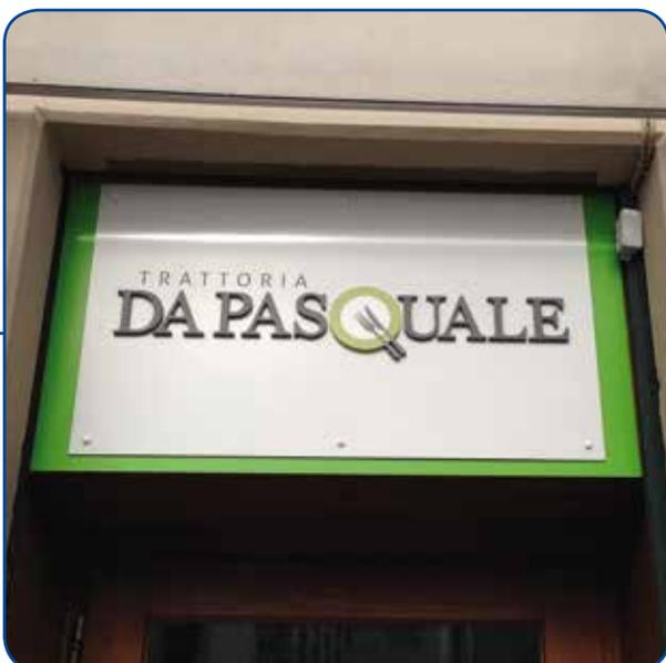
Buchstaben aus Acrylglas gefräst. Logo mit Digitaldruck belegt und auf Trägerplatte montiert.
