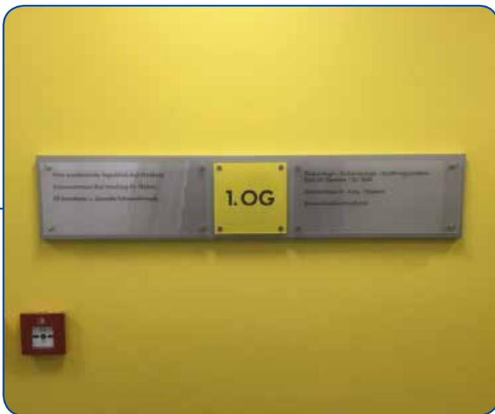
Etagenwegweiser mit Haube aus Aluminium und ESG-Glasscheiben. Beschriftung im Folienplott und Digitaldruck.
